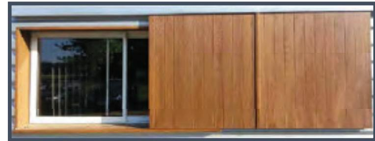
Les volets coulissants en composite renforcé en fibre de verre conviendront à toutes les habitations, et apporteront une touche de modernité avec l'aspect traditionnel du bois. Composé d'un rail haut aluminium à fixer en façade, de chariots équipés de roulements à billes inox et étanches (capots et caches en alu peints selon RAL), de butées de fin de course à lame inox (progressif et sans à-coups et d'un rail bas intégré dans un vantail avec olives).
